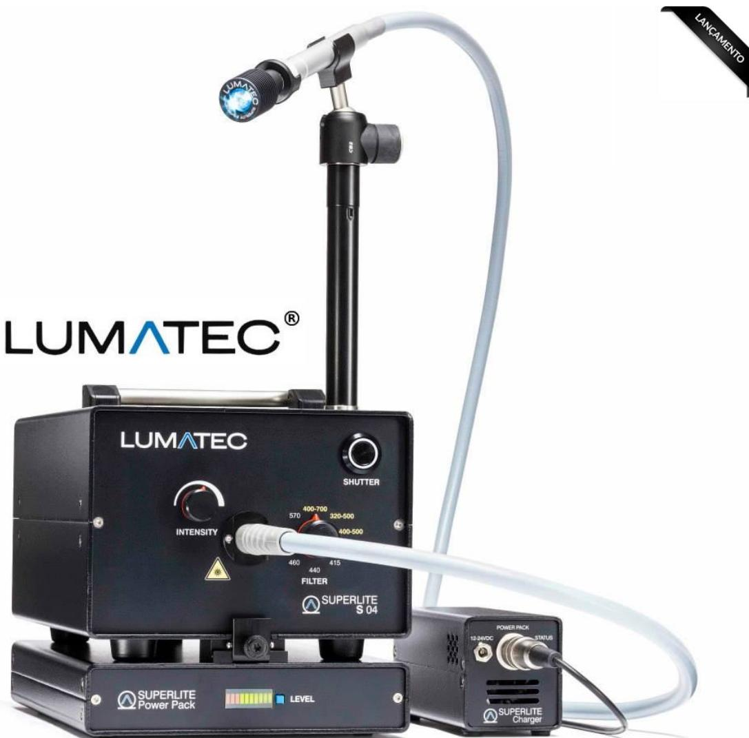
Equipamento de luz forense multiespectral portátil modelo Superlite S04 para uso específico de detecção de vestígios de DNA:
